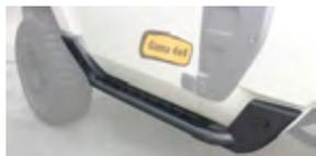
Estribo especial reforçado p/ Troller 2015 em diante Cor cinza
